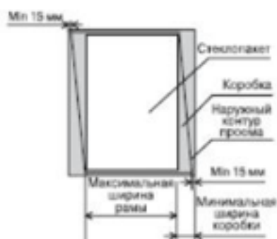
Рис. 10. Определение размеров окна при перекосах проема
